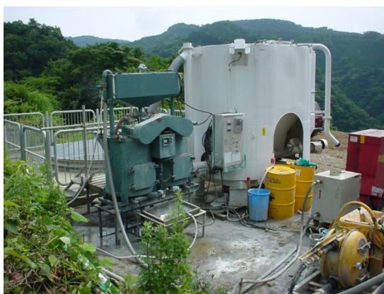
図 5.10.1 二槽式グラウトミキサーおよび小型セメントサイロからなる注入プラントの例
