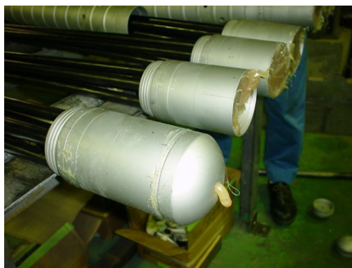
図 5.6.5 防錆材の充填
