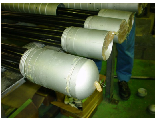
図 5.6.6 防錆材の充填
