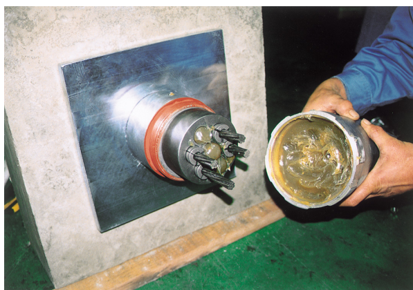
図 1.2.7 くさびによる頭部定着の方式
