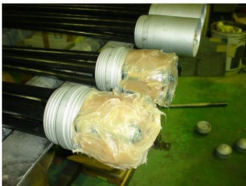
図 3.5.6 固定金具内の充填状況
