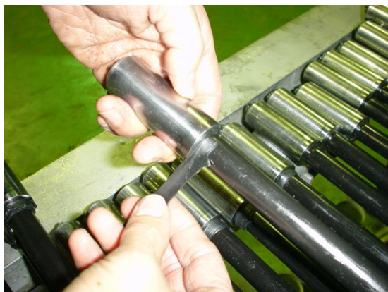
図 5.6.2 アンボンド PC 鋼より線の端部処理 (圧着グリップ側)
