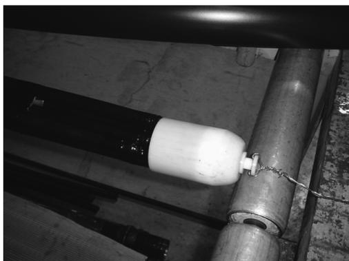
図 5.6.7 樹脂製挿入キャップ
