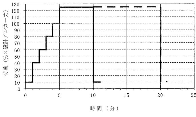
図 7.5.1 載荷計画の一例（ランク A）
