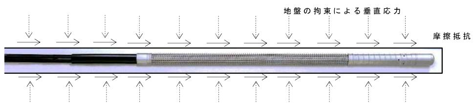
図 1.1.3 SSL-CE 型アンカ一体
