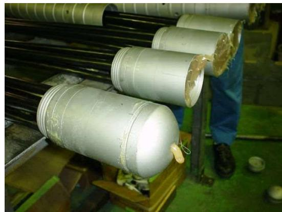
図 5.6.6 防錆材の充填
