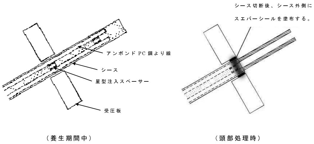
図 5.11.1 シースの切断および止水
