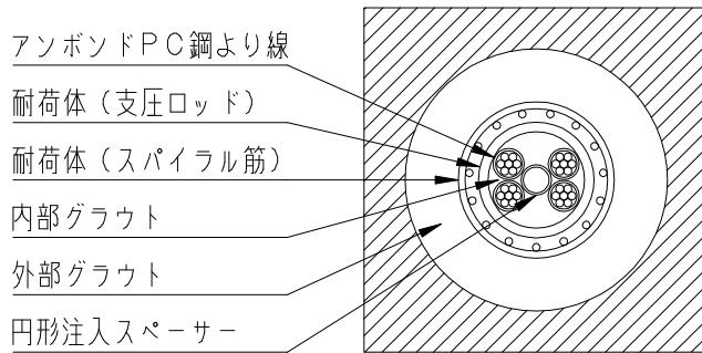
図 6.2.1 アンカ一体部（耐荷体部分）の防食構造
