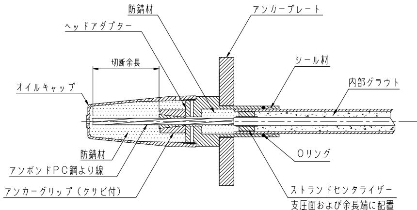
図 6.4.1 アンカー頭部の防食構造
