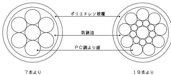
図 3.2.1 アンボンド PC 鋼より線
