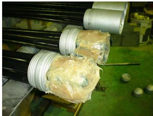
図 3.5.6 固定金具内の充填状況
