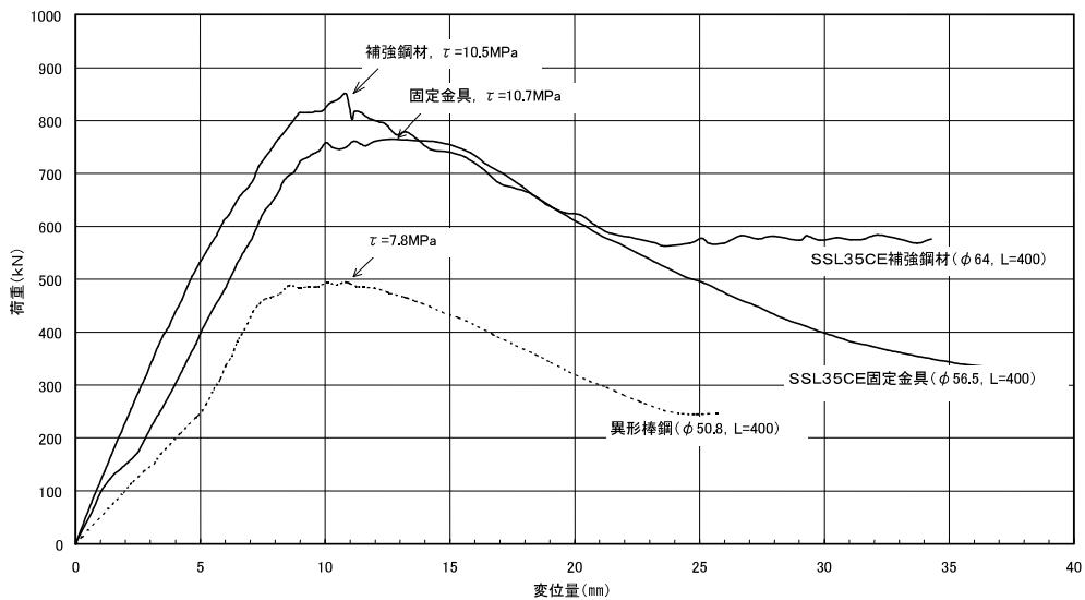
図 4.11.2 付着強度特性試験結果
