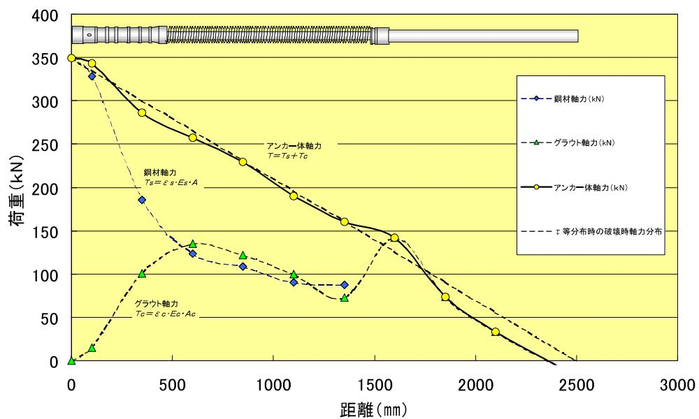
図 4.10.3 破壊直前時の軸力分布の測定例（350kN 載荷時）
