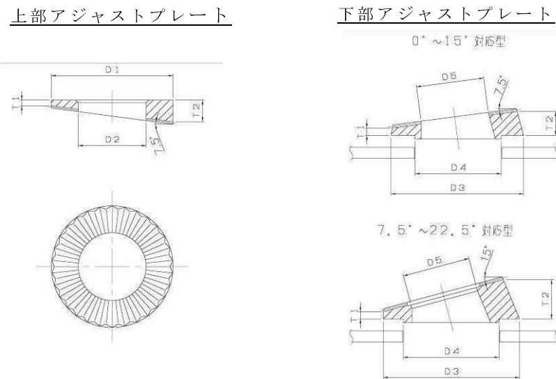
図 3.4.5 アジャストプレート構造図
