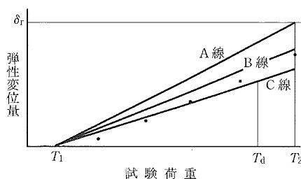
図 7.4.3 荷重－弾性変位量曲線
