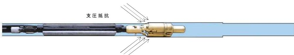
図 1.1.2 SSL-M 型アンカ一体
