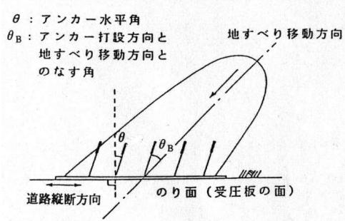
図 4.3.2 アンカー打設角度と地すべり移動方向および道路縦断方向との関係
