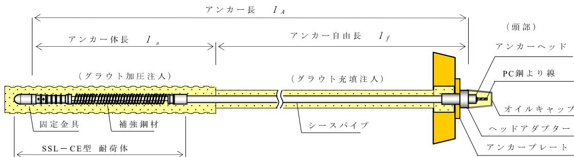
図 1.2.3 SSL-CE型アンカーの構造
