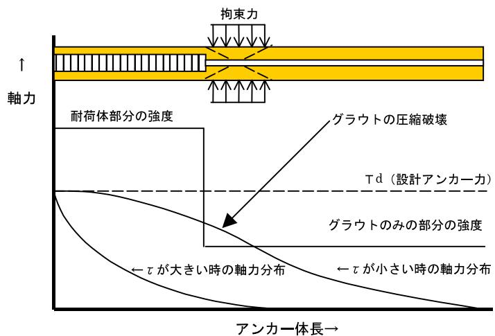
図 4.10.2 アンカーボディの強度と設計アンカーアー力、軸力分布の関係
