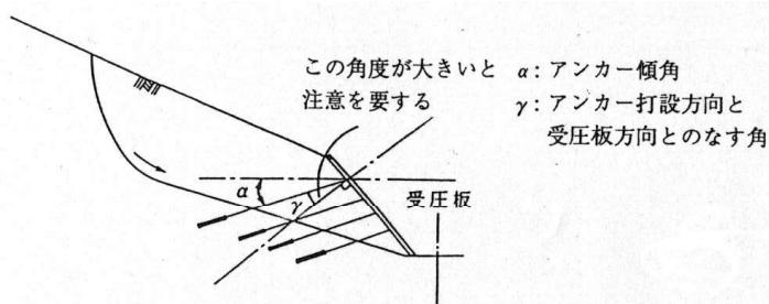
図 4.3.3 受圧板とアンカーの打設角度の関係
