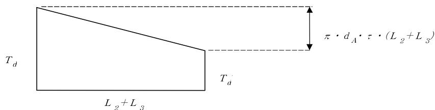
(周面摩擦抵抗による、軸力の低減モデル)
