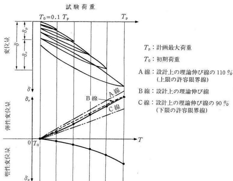
図 7.4.2 荷重-弾・塑性変位量曲線
