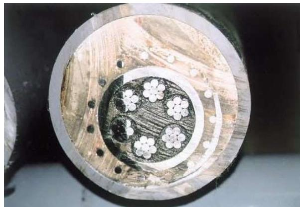
図 1.2.5 アンカ一体部の防食構造
