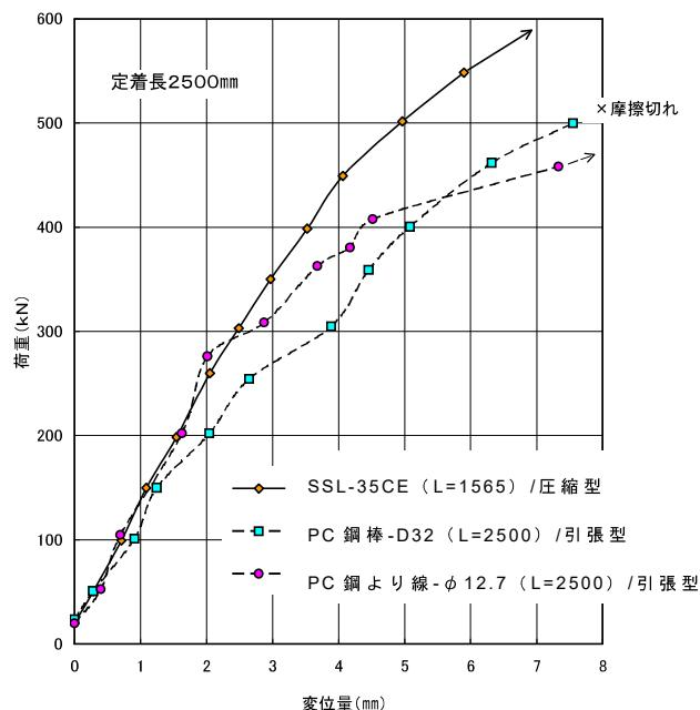
図 1.2.4 荷重端変位量の比較
