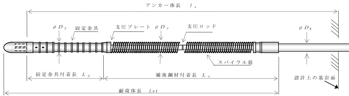
図 4.9.2 アンカーボディの構造
