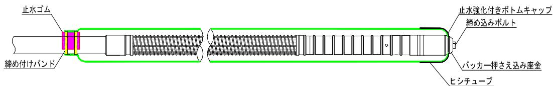
図 3.6.5 CE 型設置パッカー構造図
