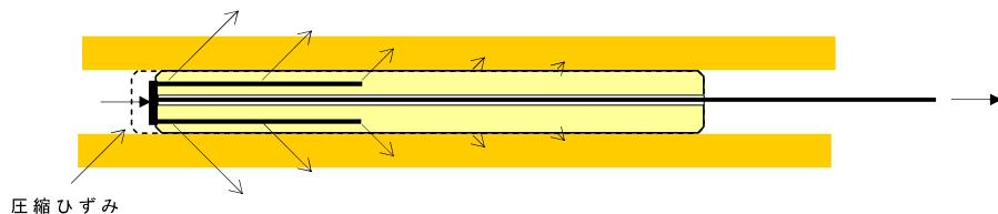
図 1.2.2 摩擦・圧縮型における荷重伝達
