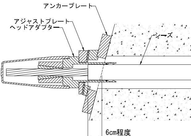
図 5.11.2 アジャストプレート使用時のシース切断位置
