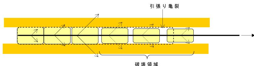
図 1.2.1 摩擦・引張り型における荷重伝達
