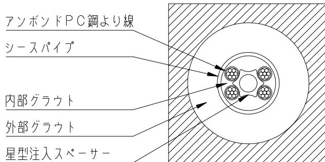
図 6.3.1 アンカー引張り部の防食構造
