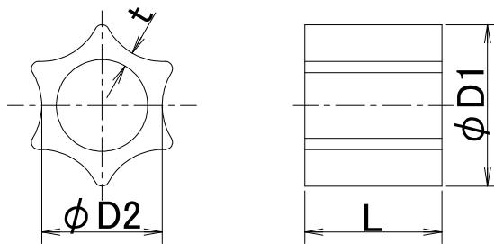
図 3.5.2 65CE 用星型注入スペーサーの形状
