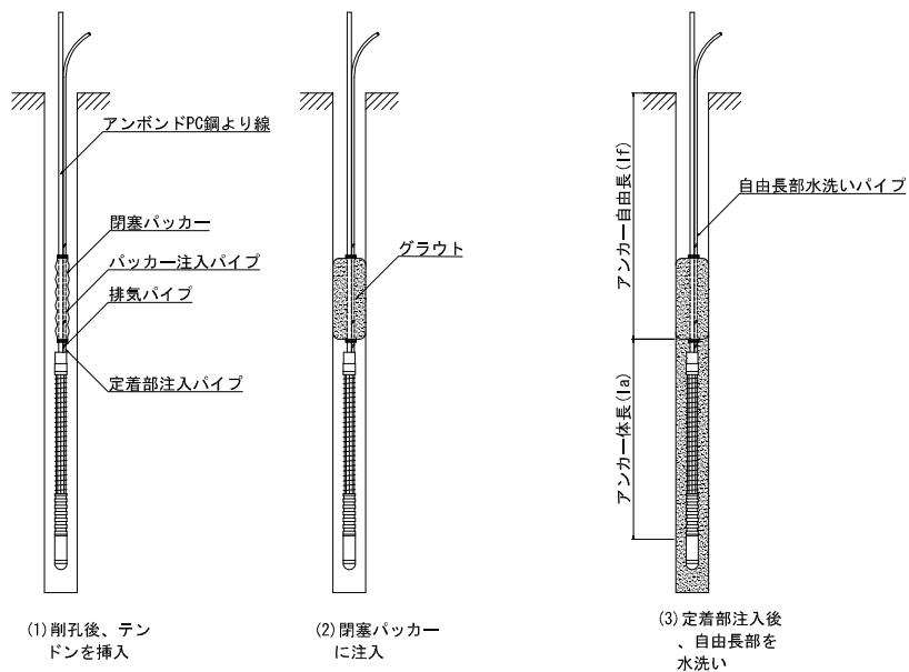
図 7.3.1 引抜試験用アンカーの設置例
