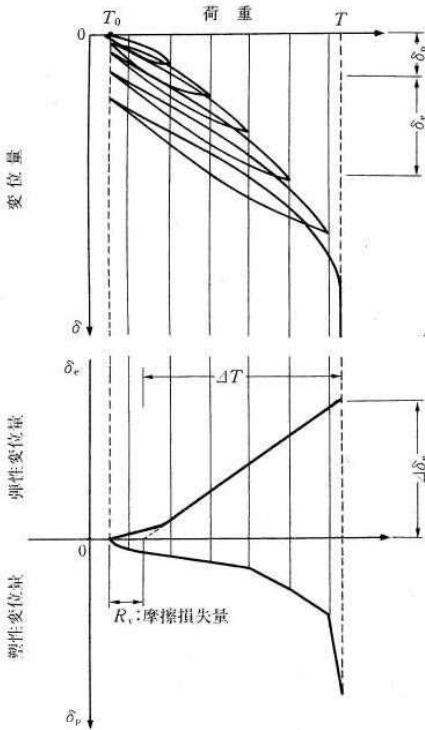
図 7.3.3 荷重一変位量曲線の一例（引抜き試験）
