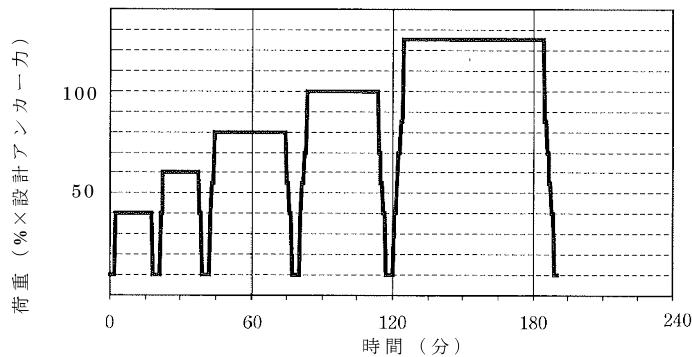
図 7.4.1 適性試験の載荷計画の一例（ランク A）
