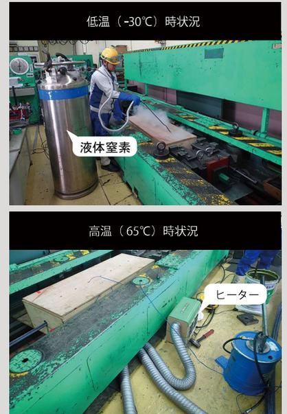
供用環境を想定し、定着用膨脹材によるテンドングリップ(定着具)の耐久性確認試験を実施しました。高・低温時でもテンドンの極限引張り力 95%をクリアし、常温時と同等の性能が確認されました。また、全ての試験後供試体にピンホールは確認されませんでした。
