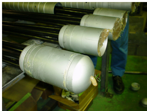
図 5.6.5 防錆材の充填
