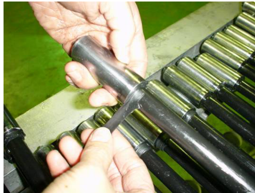
図 5.6.2 アンボンド PC 鋼より線の端部処理
