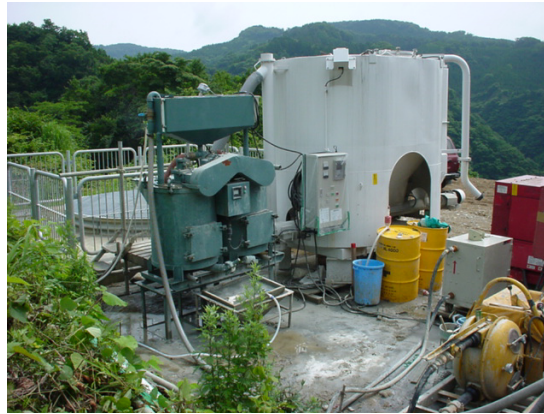
図 5.10.1 二槽式グラウトミキサーおよび小型セメントサイロからなる注入プラントの例
