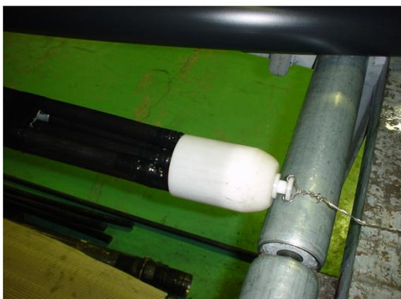
図 5.6.8 樹脂製挿入キャップ
