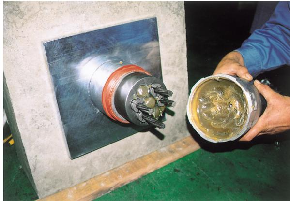
図 1.2.7 くさびによる頭部定着の方式
