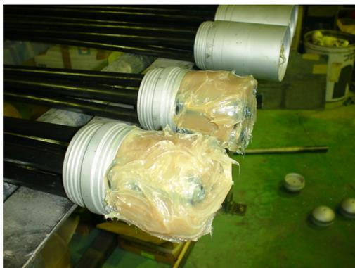
図 3.5.6 固定金具内の充填状況
