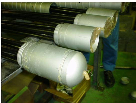
図 5.6.6 防錆材の充填
