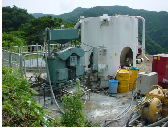
図 5.9.1 二槽式グラウトミキサーおよび小型セメントサイロからなる注入プラントの例
