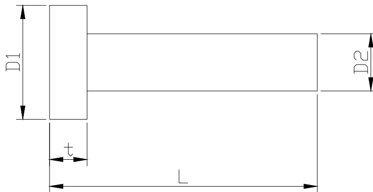
図 3.4.4 QSA 用ヘッドアダプターの形状
