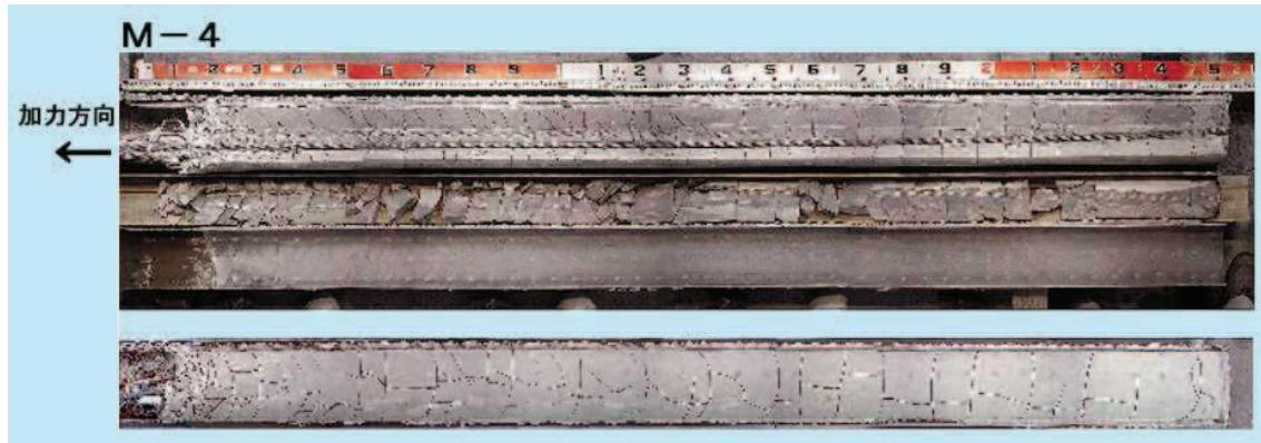
写真-1 周面摩擦引張型アンカー実物大試験によりアンカ一体に発生した引張亀裂
