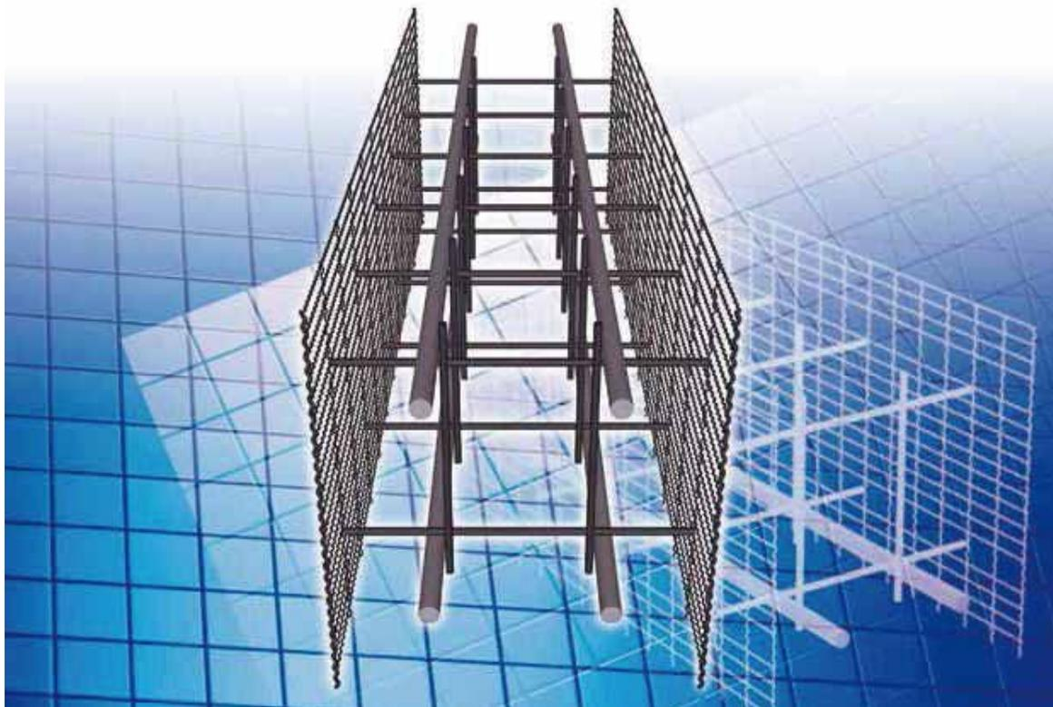
フレームセット工法EEタイプは、フレーム部材全体にメッキを施したクリンプ金網を使い、錆の発生は極めて少なく、耐久性に優れた工法として、Q & Sフレーム工法の一環として開発したこうほうです。
